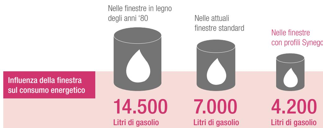
Riferito a: superfici delle finestre: 25 m<sup>2</sup>, consumo di gasolio in 25 anni; finestre in legno con valore U = 2,79W/m<sup>2</sup>K, Finestre Standard con valore U = 1,36W/m<sup>2</sup>K; con SYNEGO valore U = 0,66W/m<sup>2</sup>K
