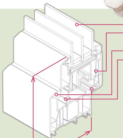
**Triplo vetro isolante con protezione termica, vetro fino a 51mm**
